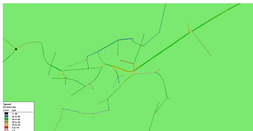
Figura 76 Extras din modelul de trafic privind viteza de circulație
