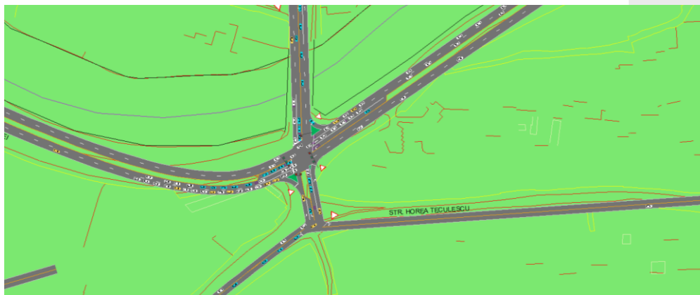
Figura 77 Extras din modelul de trafic de la intersecția str. Consiliul Europei - str. 1 Decembrie - str. Gheorghe Lazăr cu modul de formare a cozilor de circulație
